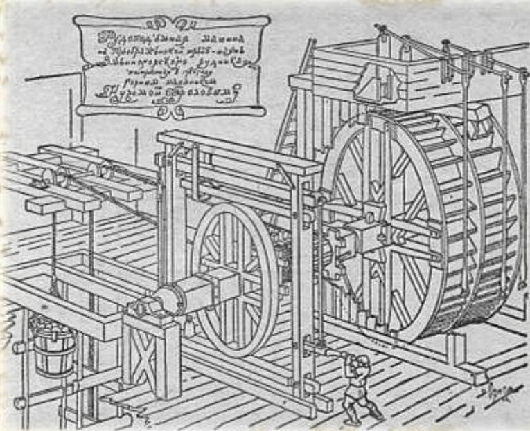
2 км пробегала вода, вращая колесо высотой с 5-этажный дом: диаметр верхнебойных колес составлял 17 м.
